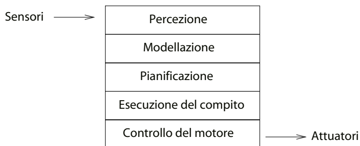
Figura 2.3 Ciclo percezione-pensiero-azione: scomposizione funzionale del sistema di controllo di un robot mobile. L'informazione sensoriale è elaborata in maniera sequenziale, utilizzando un modello interno del mondo.
